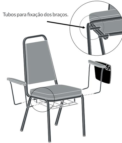
A prancheta escamoteável Plaxmetal possui um mecanismo de liberação automático que é acionado com um simples toque feito pelo usuário ao levantar-se, onde a prancheta retorna automaticamente à sua posição inicial proporcionando a saída imediata desse usuário além de liberar o espaço físico para passagem e tráfego rápido em situações de emergência.
